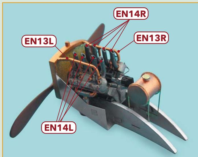
**6** Приклейте на свои места трубки радиатора и выхлопные трубы.
